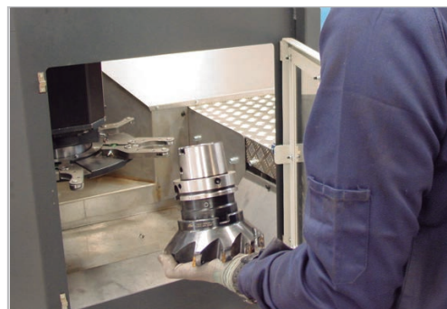
Tool Storage Cargador automático
