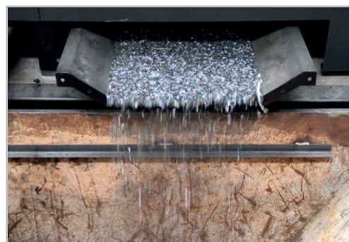
Dross collection with VIBRATEC® System Recogida de escoria con sistema VIBRATEC®
