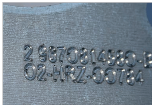
Piece marking Detalle marcado de piezas
